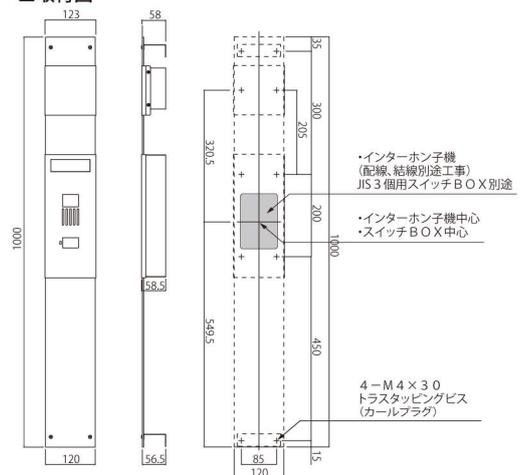
アクリル板は六角穴付きボルトで固定します。施工時は六角レンチ(呼び2.5)をご用意ください。
