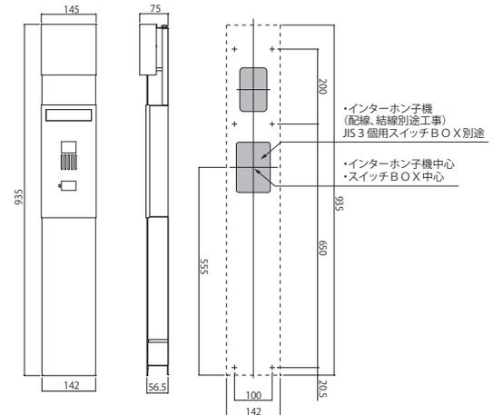
アクリル板は六角穴付きボタンボルトで固定します。施工時は六角レンチ(呼び2.5)をご用意ください。
